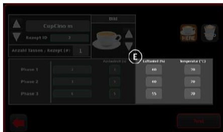
5. Ajuste de fases y cantidades de volumen líquido [E]
