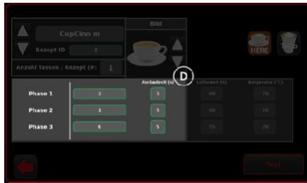
4. Ajuste de fases y cantidades de volumen líquido [D]
